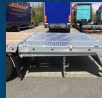
Hydraulisch neerlaatbare achterkant met 5,5 t hefkracht
