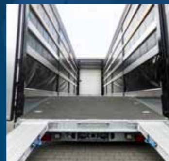
Aufleger mit absenkbarem Heck und Auffahrampen
