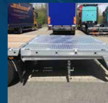
Hydraulisch absenkbares Heck mit 5.5 t Hubkraft
