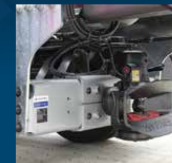
Pneumatisches Tiefkupplungssystem mit Fernanzeige
