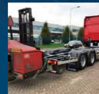
Wechselrahmen mit Staplerhaltung
