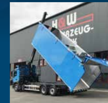
Trennwandsystem für Trennung von Grün Braun und Weißglas inkl. hydraulischer Heckklappe
