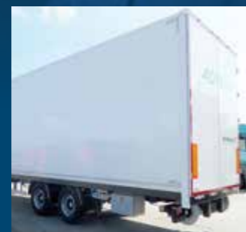
Aufnahme für Docking-Station zur vollautomatischen Be- und Entladung
