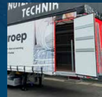
Zugangstür in der Seitenwand
