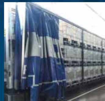
Optimierter Laderaum für bis zu 112 IBC-Leergebinde
