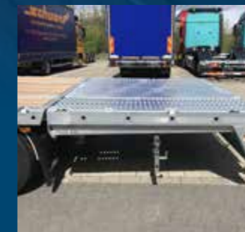
Hydraulisch absenkbares Heck mit 5.5 t Hubkraft
